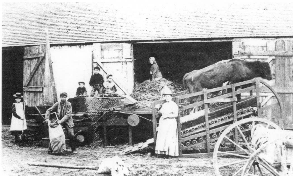
Un moulin à battre le grain, actionné par le bœuf marchant sur un tapis roulant. (ANQ, Collection Musée des Grondines.)
